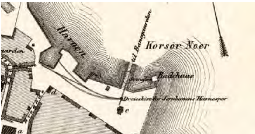
Den snævre plads i havnen betød installation af en drejeskive, så godsvogne kunne køre til havnen. Drejeskiven blev imidlertid undgået, da de senere broer lå mere sydligt og havde en anden retning, så vognene kunne køre til havnen via et spor på et opfyldt område mod øst (Trap 1858, Kongelige Bibliotek).
