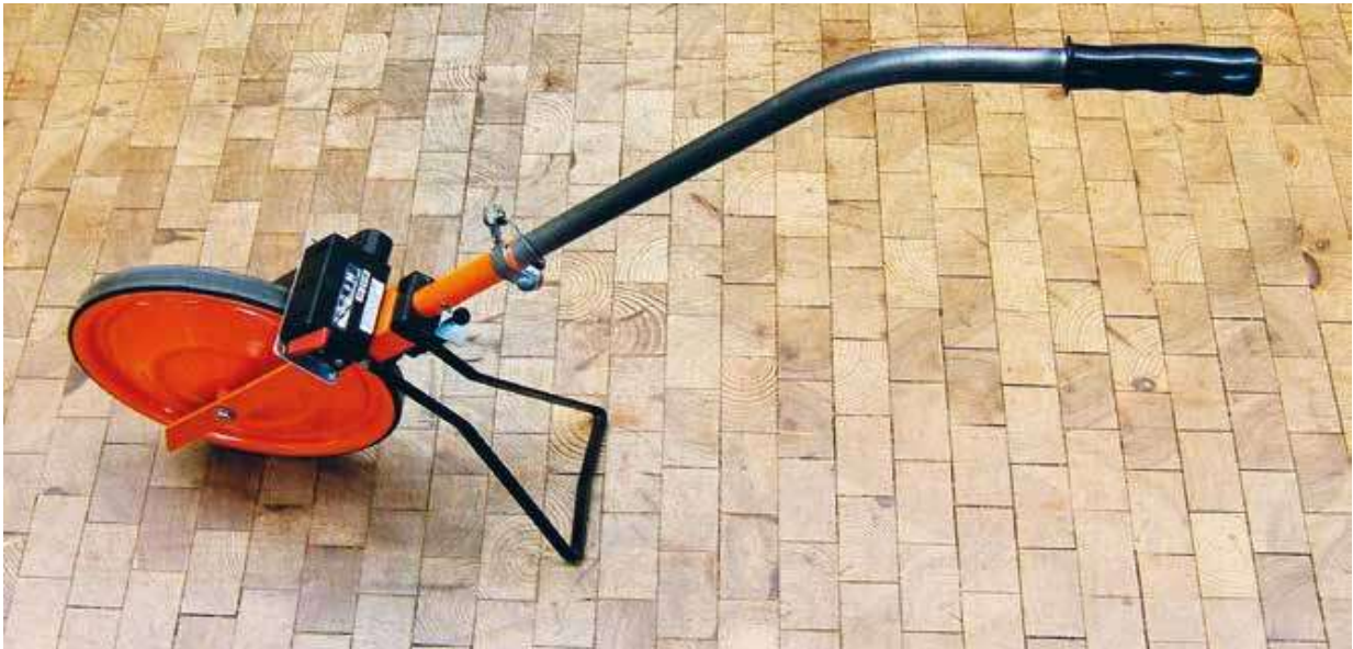
Hodometre anvendes stadig ved opmåling af ledninger o.l. (Wikipedia).
