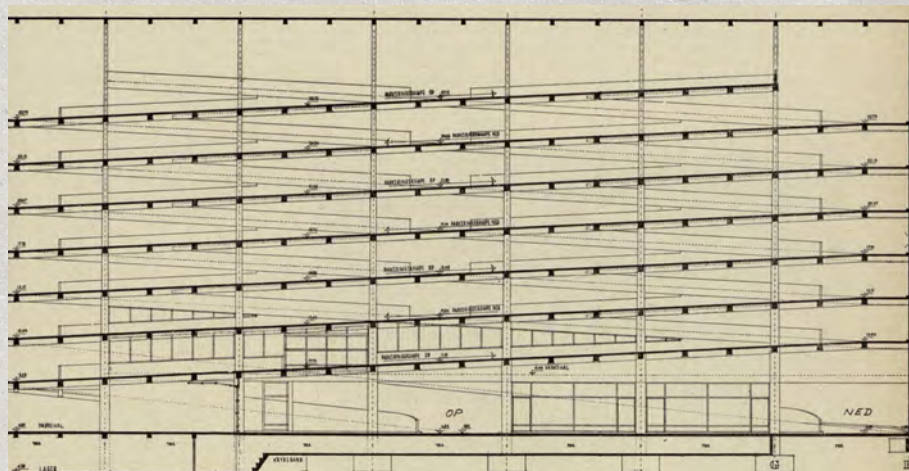
Figur 5. Arkitekten for BP-parkeringshuset i Nyropsgade i 1958 valgte at undgå op- og nedkørselsrampes for i stedet at lade parkeringen foregå på skrå etager med trafikken i midten og parkering i siderne (Ingeniøren 1/9 1957).
