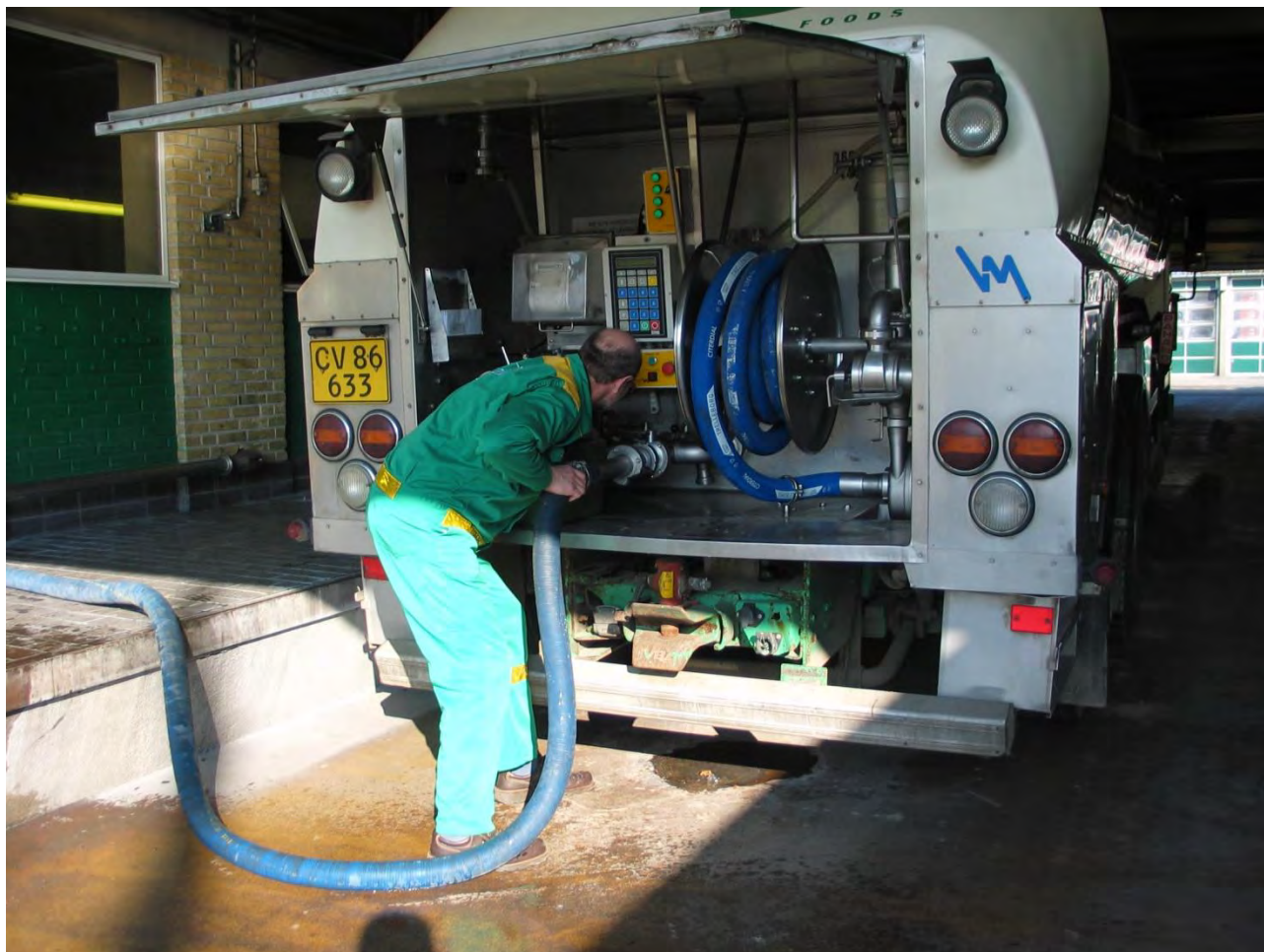
Mange virksomheder har valgt at køre med egne køretøjer. Her er det en mælketankvogn ved Grenå Mejeri i 2004, som benytter mejeriets anlæg til at rejse slanger og tanke. Foto: Jørgen Burchardt.
