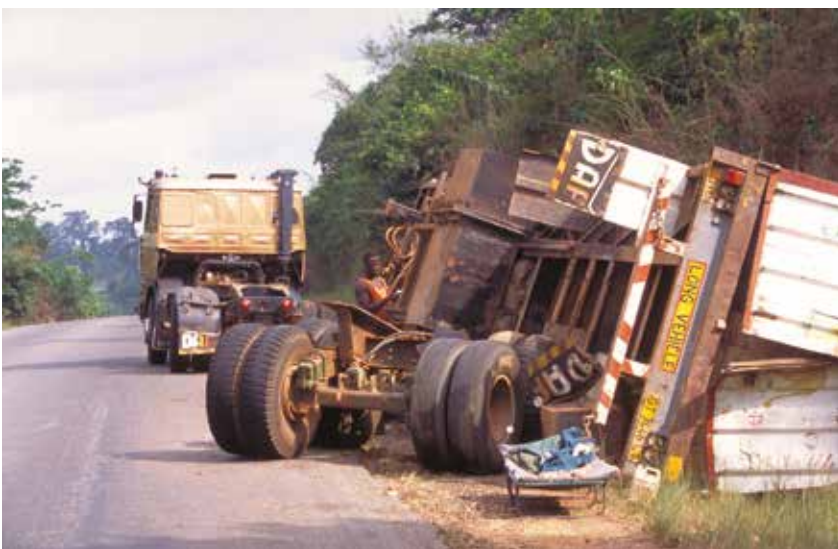
Mange ulykker med lastbiler skyldes overvægt. Denne lastbil har måske desuden haft problemer med slidbanerne på dækkene, hvor de højre dæk på anhængerens stort set ikke har mønster tilbage. Dækkene er i øvrigt højst sandsynligt købt brugt fra Europa. Foto WHO.
