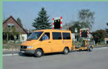
Det var ikke tilfældigt, at målevognen fra Vejdirektoratet havde store skilte med advarselslys. Det var farligt, når faldlod anvendtes på trafikeret vej, da udstyret skulle stå stille nogle minutter. Faldlodet er en Dynatest 8000 fra 2001. Foto: Hildebrand og Rasmussen 2002.
