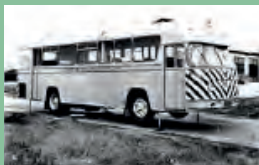
Büssing målevognen var en ombygget bus. Her ses den med støttebenene slået ud og klar til at måle. Foto: Banke.
