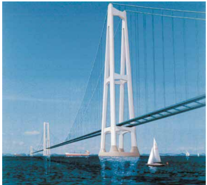
Broen over Gibraltarstrædet mellem Marokko og Spanien kan udformes som en serie 3.500 m lange hængebrofag med offshore lignende fundamenter på 300 m dybde. Illustration Jørgen Rasted for COWI.
