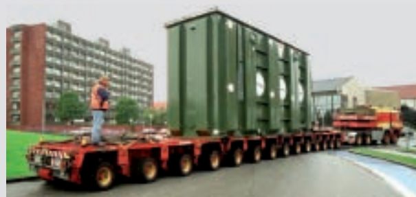
Transport af transformere, hvor blokvognen i alt vejer 280 tons. Foto: Torben Rafn & Co.
