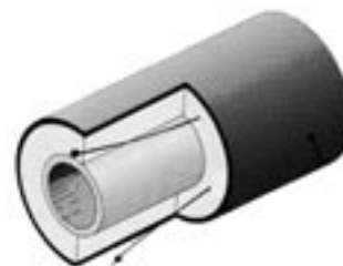
Et moderne fjernvarmerør som det leveres fra rørfabrikken. Omkring det inderste stålrør ligger isolering og yderst er der et hårdt beskyttelseslag. Inde i isoleringen ligger elektriske ledninger, som bruges til at lokalisere eventuelle skader.
